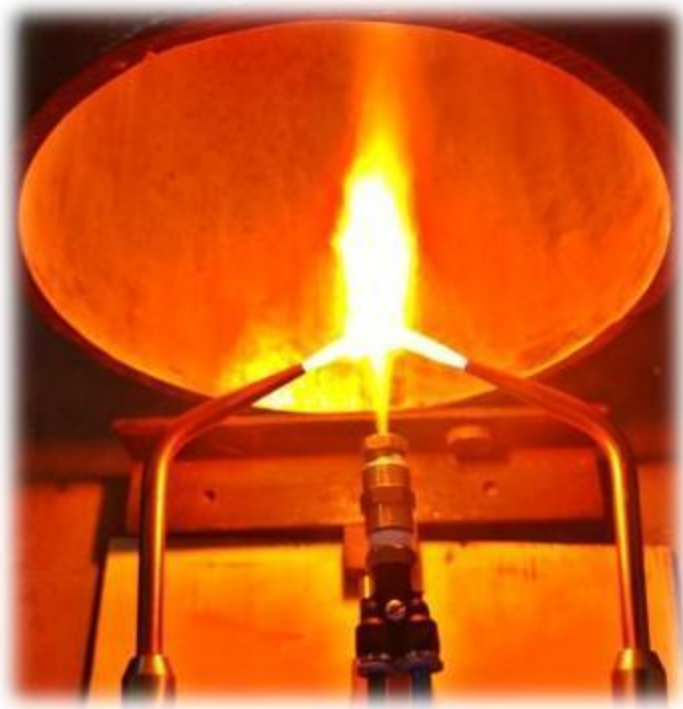
Equipo de pirólisis de aerosol en llama desarrollado por el grupo para la obtención de silicatos cálcicos, uno de los principales componentes del clínker.
